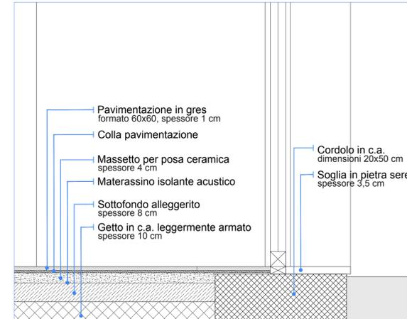
Dett01 - solaio copertura vano scala
